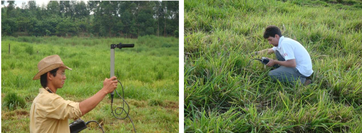
Figura 13 – Avaliação da interceptação luminosa. Medições acima (esquerda) e abaixo (direita) do dossel
