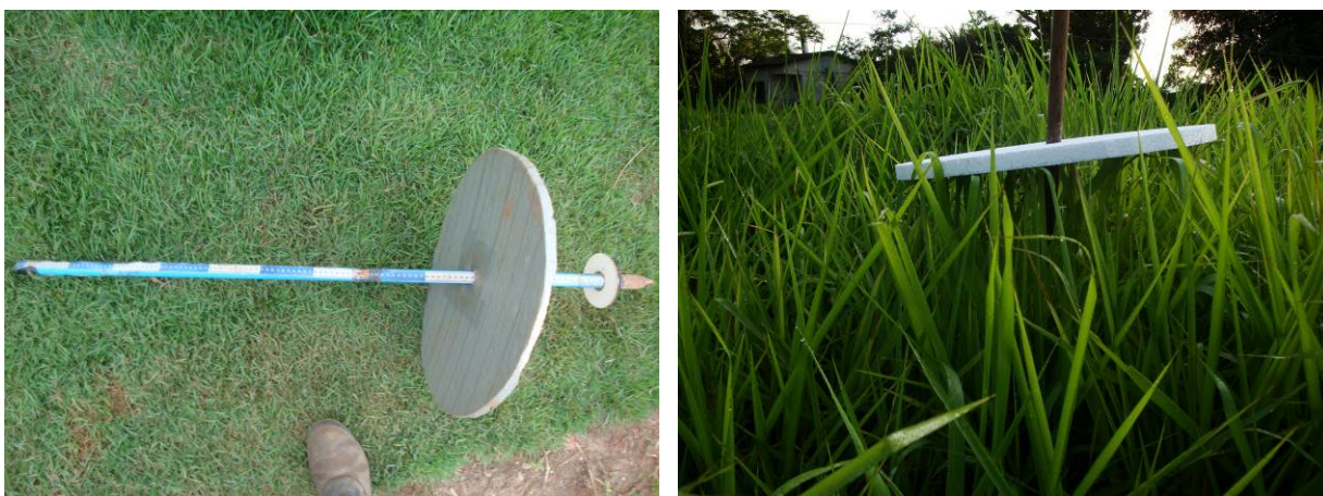
Figura 12 – Instrumento utilizado para medir a altura da pastagem
